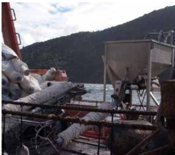
Figura 66. Tubos de PVC carregados com malha de algodão e ensacados ao lado da máquina de semear.
