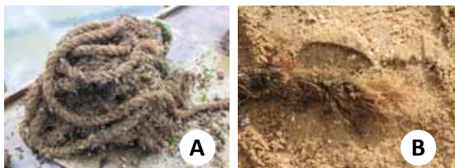
Figura 20. (A) cabo manufaturado com resíduos de redes de nylon; (B) cabo partido após quatro anos de uso com máquina de colheita hidráulica.
