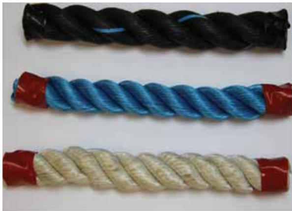
Figura 13. Cabo de éter de polifenileno (acima), cabo de polipropileno (meio) e de poliamida (abaixo).
