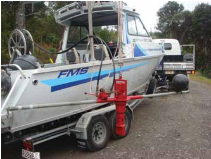
Figura 57. Embarcação com broca hidráulica para instalação de âncoras trado de pequeno porte.
