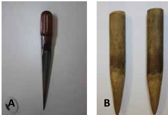
Figura 17. (A) espicha de aço inox com cabo de madeira; (B) caverão confeccionado com um cabo de madeira roliça.
