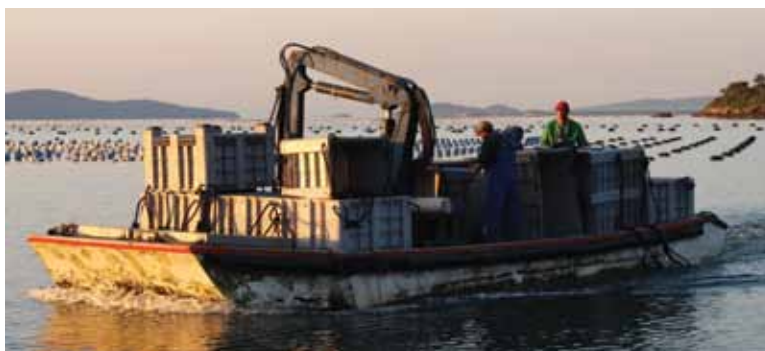
Figura 46. Embarcação de pequeno porte com grua hidráulica e espaço para acondicionamento de bins em Santa Catarina.
