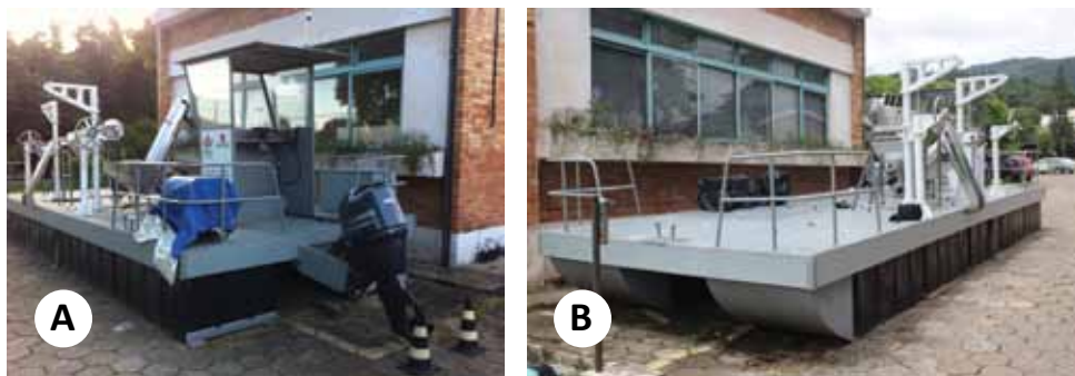
Figura 44. Vista da popa (A) e proa (B) de uma balsa de madeira com motor de popa e flutuadores de polietileno de alta densidade.
