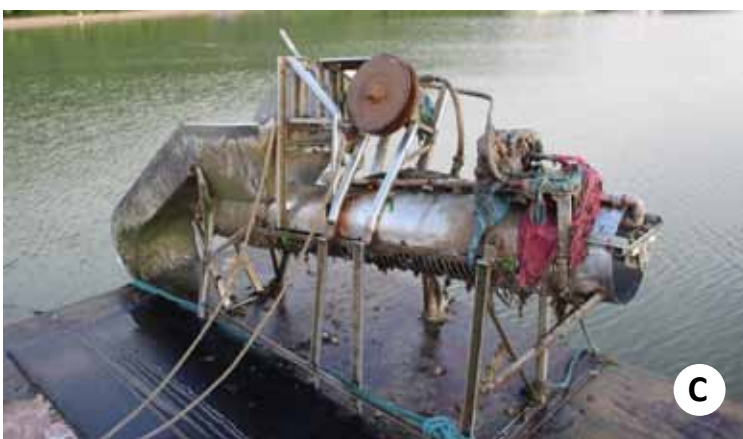
Figura 26. Máquina de pequeno porte desagregar mexilhões utilizadas em Santa Catarina: (A) motor elétrico (B) motor a gasolina e (C) hidráulica.
