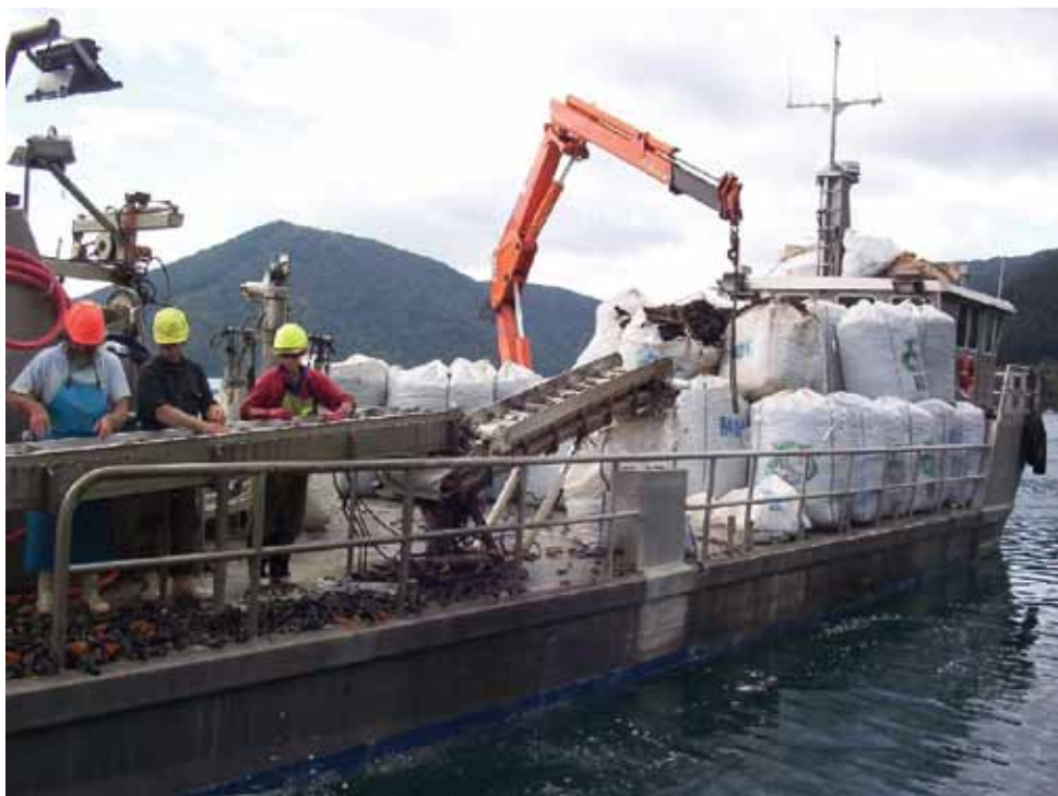
Figura 47. Embarcação de alumínio de grande porte com grua hidráulica e big bags na Nova Zelândia.
