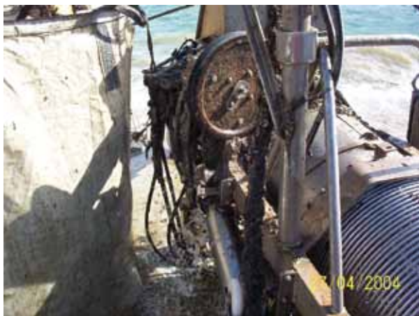
Figura 39. Sistema para lavagem do cabo de cultivo, antes de seu acondicionamento em um big bag .
