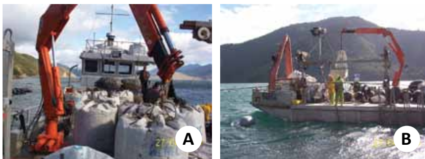
Figura 33. Emprego da grua hidráulica em operação com big bags nas etapas de (A) colheita e (B) semeadura.
