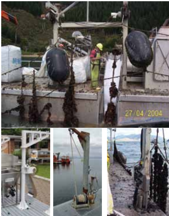
Figura 32. Elevadores de longline com acionamento hidráulico.
