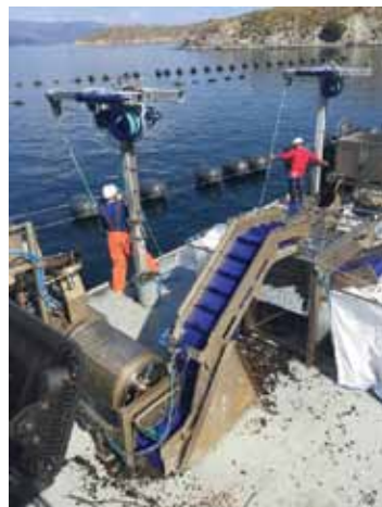
Figura 38. Esteira transportadora posicionada entre máquinas de desagregar e classificar mexilhões. Foto: Misya Su Ürünleri.
