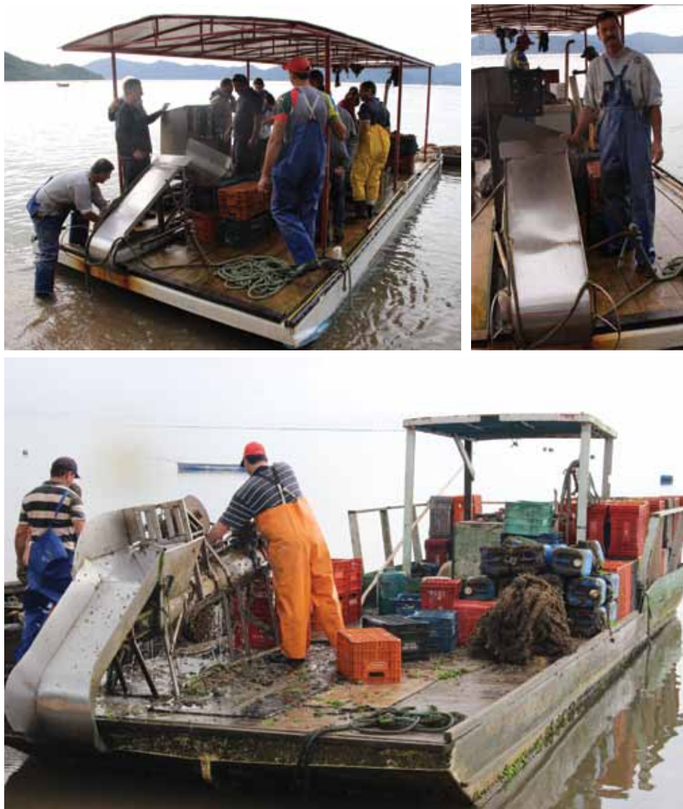
Figura 43. Embarcações de pequeno porte construída em madeira, com equipamento para colheita mecanizada
