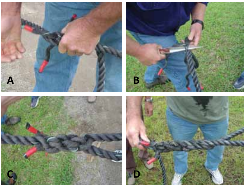
Figura 18. (A e B) fazendo costuras em cabo com uma espicha; (C) costura de alça; (D) costura de mão
