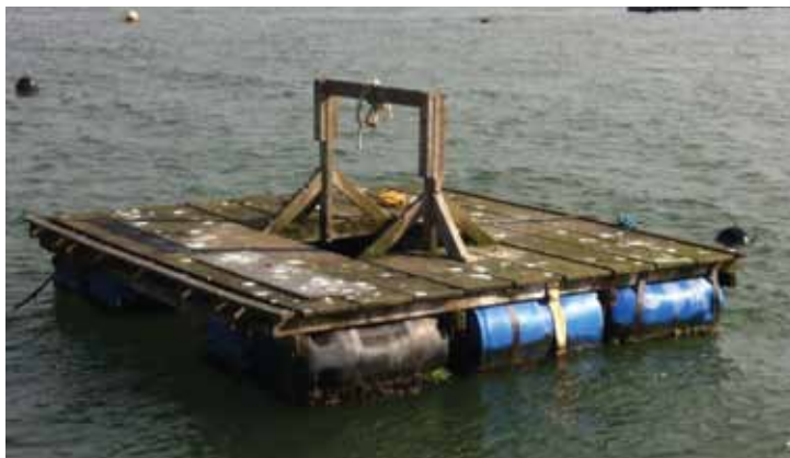
Figura 55. Pequena balsa para transporte individual de poitas.
