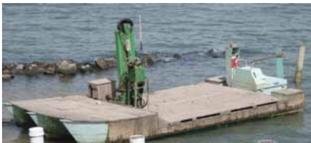
Figura 35. Guia hidráulica instalada sobre balsa de pequenas dimensões em Santa Catarina.
