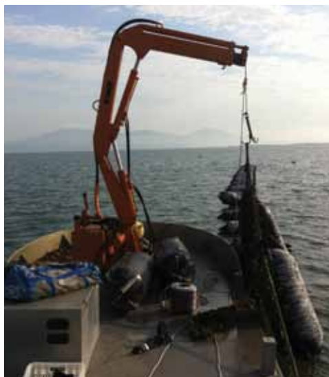
Figura 34. Grua hidráulica empregada na manutenção de longline duplo em Santa Catarina.
