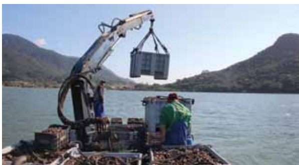
Figura 35. Guia hidráulica instalada sobre balsa de pequenas dimensões em Santa Catarina.
