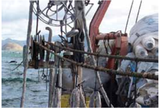
Figura 40. Rodas estrela com motor hidráulico em operação durante semeadura de mexilhões.
