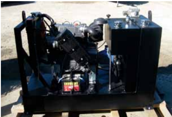
Figura 41. Grupo gerador com bomba hidráulica para operação das máquinas de cultivo de mexilhão. Foto: Asnco Engineering.
