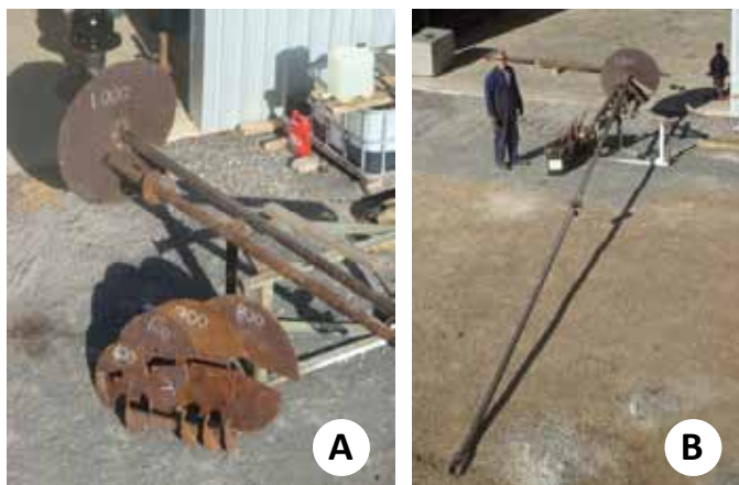
Figura 56. (A) Âncora trado com diversos modelos de prato, (B) Eixo prolongado para fixação a partir da embarcação. Foto: Graham Fielder (Fielder Marine Services).
