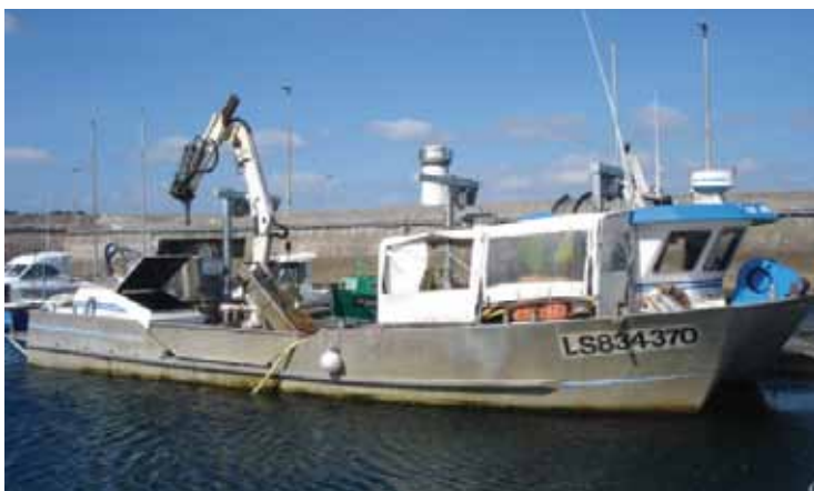
Figura 49. Embarcação de médio porte com grua hidráulica. Foto: Joe Franklin Jnr (Quality Equipment).
