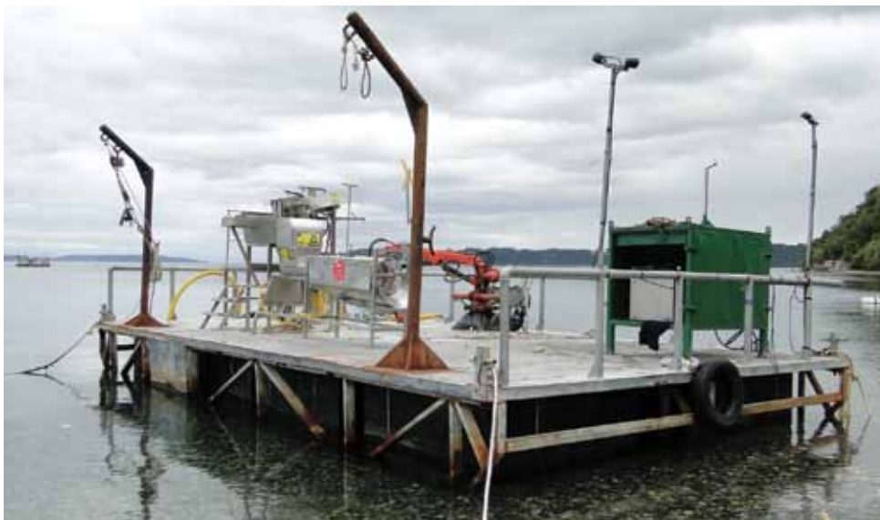
Figura 42. Balsa de aço rebocável com equipamentos hidráulicos e grua.
